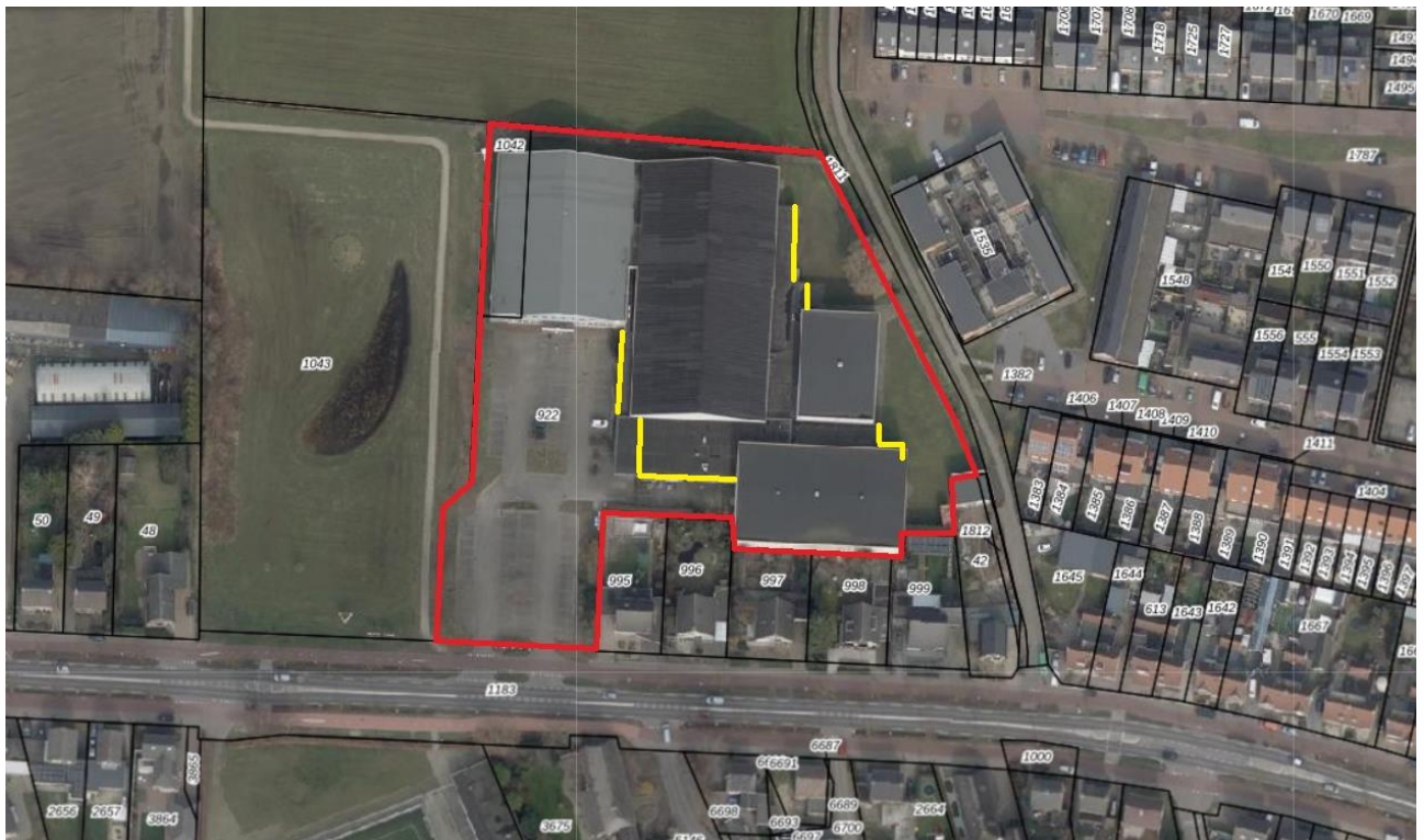
Figuur 4.4.1. In het plangebied (rood omlind) zijn diverse spouwen aanwezig met open stootvoegen (gele lijnen). Bron: Kadastrale Kaart .
